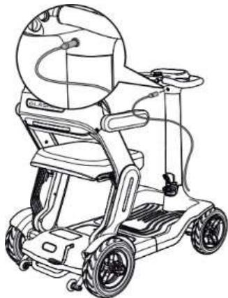
1. Apague el scooter eléctrico y conecte el cargador específico para el scooter ROC en la toma de carga.
