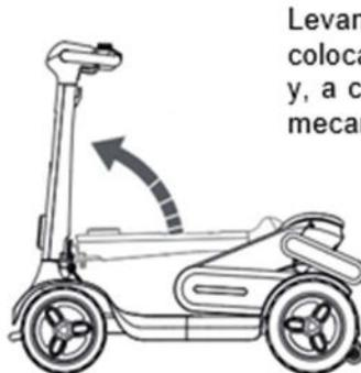
Levante el manillar hasta colocarlo en posición vertical y, a continuación, bloquee el mecanismo de plegado.
