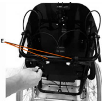
D) Afloje los tornillos (E) del tubo transversal con una llave Allen y una llave inglesa.
