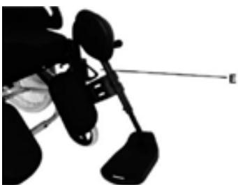
Os apoios de pés podem ser retirados apertando a alavanca (E) para a frente; depois rode o apoio de pés para fora. Depois de estar num dos lados, puxe para cima pelo apoio de pés.
