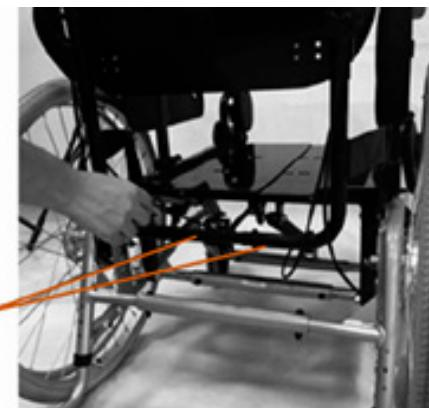
C) Desaperte os parafusos (D) da estrutura tubular com uma chave Allen e uma chave inglesa.
