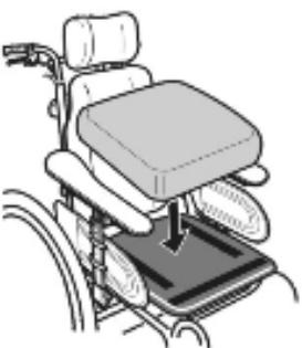
E) Ajuste todas las partes aflojadas al ancho requerido y luego vuelva a apretar los tornillos (B/C/D/E). Por último, inserte de nuevo el cojín.
