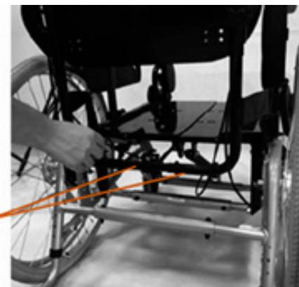
C) Afloje los tornillos (D) de la estructura tubular con una llave Allen y una llave inglesa.
