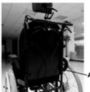
Retire a almofada do encosto puxando para a frente até separar as tiras de Velcro. Desaperte as duas borboletas (A) e puxe o encosto para cima. Coloque o encosto e a almofada no assento, onde podem permanecer durante o transporte da cadeira. Tenha cuidado com os cabos que vão da roda aos punhos quando retirar o encosto e o colocar em cima do assento.
