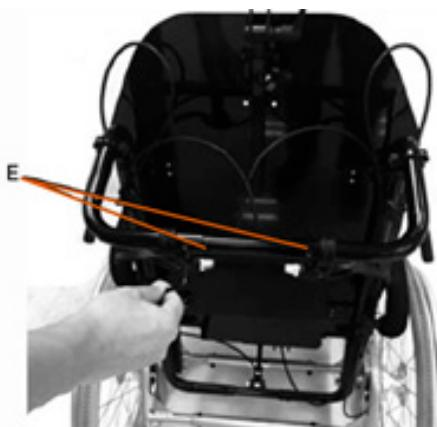
D) Desaperte os parafusos (E) do tubo transversal com uma chave Allen e uma chave inglesa.
