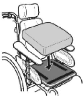
E) Regule todas as partes desapertadas para a largura desejada e depois volte a apertar os parafusos (B/C/D/E). Por último, insira novamente a almofada.
