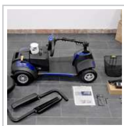
Desmontable en 5 partes
