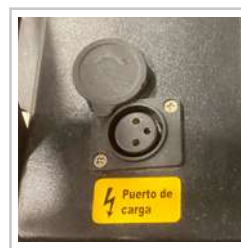
Recargable mediante un puerto de carga en el scooter
